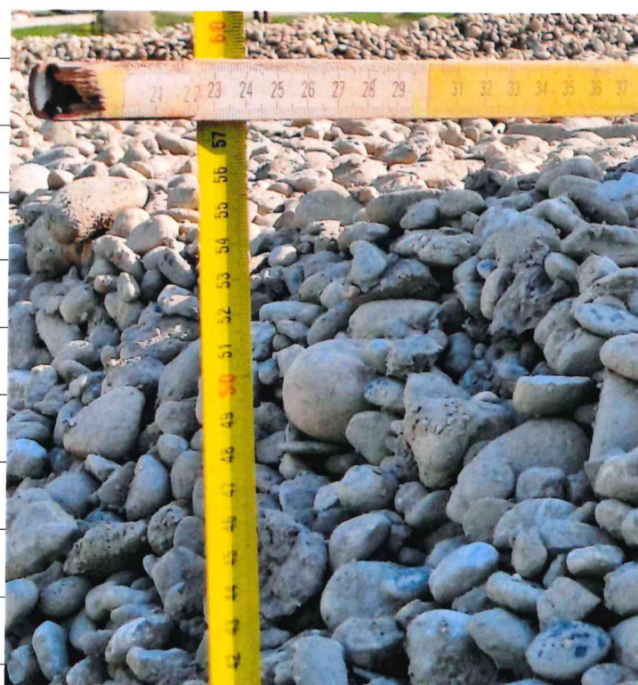
Foto 3 e 4 – Foto prove di collaudo T2 e T3 materiale inerte per lo strato di drenaggio del biogas
