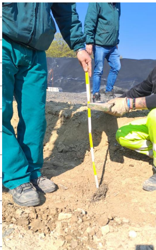
Foto 3 – Prova spessore terreno colturale nel punto S1
