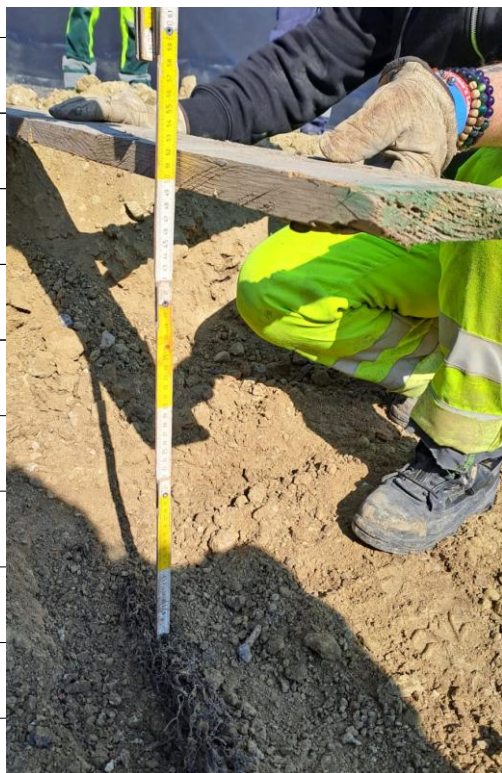
Foto 4 – Dettaglio immagine della prova spessore terreno colturale nel punto S1
