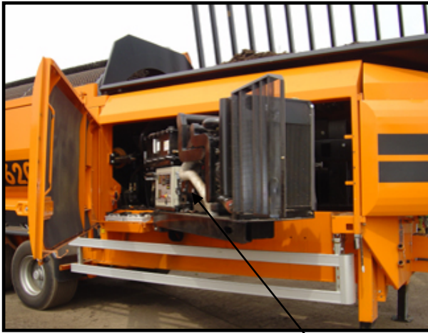
Apertura a libro del gruppo motore-impianto idraulico.
